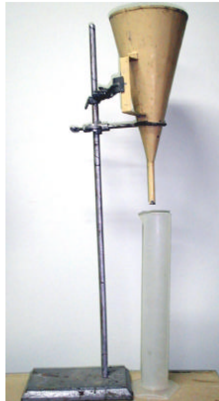
Figura 5: esquema del cono de Marsh y foto del dispositivo armado.
