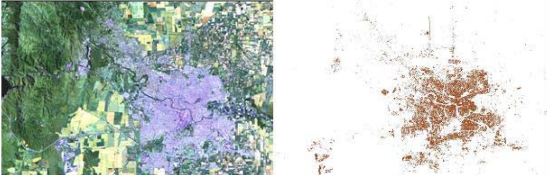
Figura 9: Izq. Imagen satelital LANDSAT 7, del día 03/12/98. Bandas (R-G-B): 3-2-1. Der. Resultado de la clasificación supervisada en un grupo.
